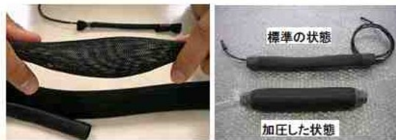
PET製の網は繊維自体に伸縮性がないため、内側から膨らまされることで短くなる。写真右にあるのがエアマッスル1.5インチの完成形
