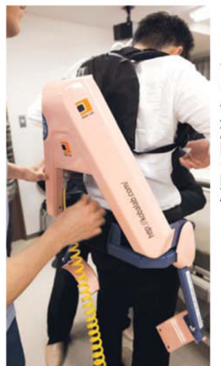
A字型フレーム内に圧縮空気で伸縮する人工筋肉を内蔵
