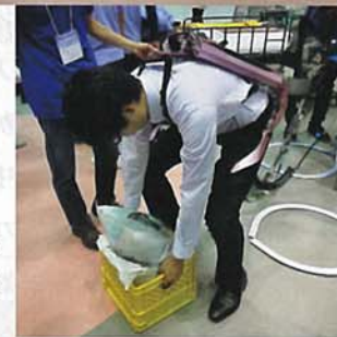
▶ マッスルスーツ®を着用したデモ。繰り返し作業を行う際の負担を軽減する。
