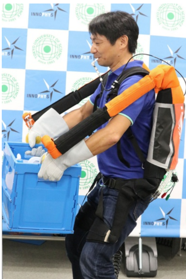
図1 腕・腰補助方式の装着型ロボット「マッスルアップパー」
