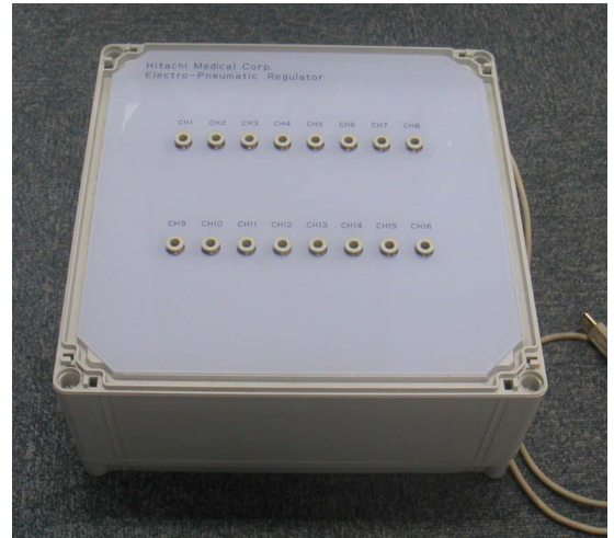
16チャンネル空気圧制御装置 幅300×奥行き300×高さ163 (mm) 質量 8kg
